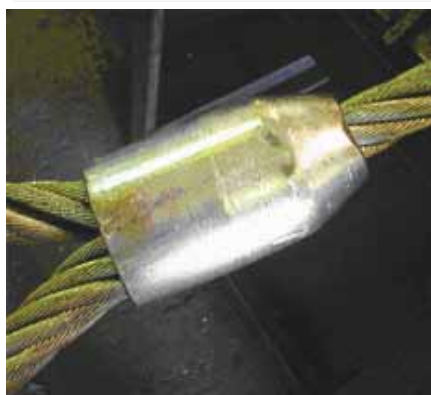
Втулка, опрессованная в наружной полости матриц
