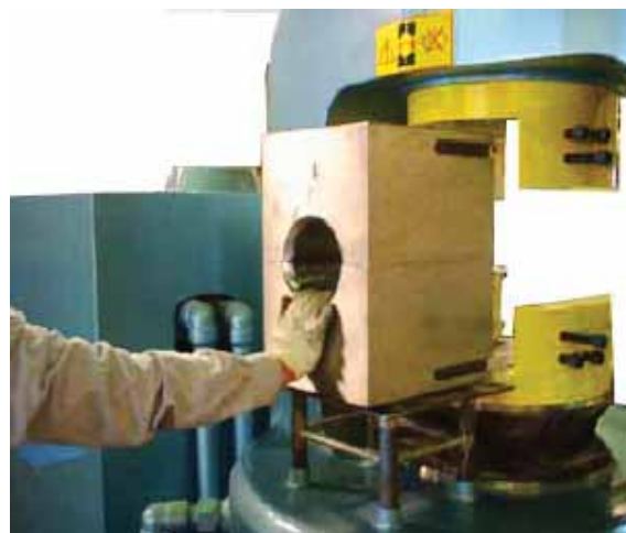
Монтаж матриц в пресс серии «Advanced»
