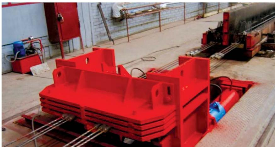
Стенд производства преднапряжённых Ж/Б конструкций
