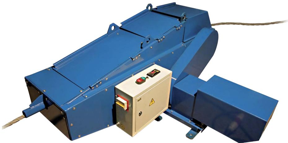
Установка ПКК-3300 предназначена для заправки пряди длиной до 250м в каналобработатель в системе преднапряжения канатной арматуры с сцеплением с бетоном.
