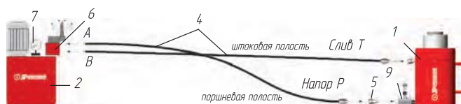
Система с одним рабочим механизмом двухстороннего действия, работающим от насосной станции с электро-, бензо-, пневмоприводом
