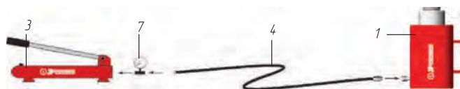
Система с одним рабочим механизмом одностороннего действия
